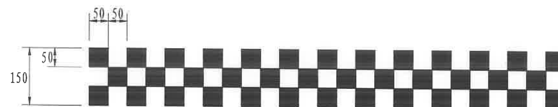
50 × 50mm 楼梯型结构标线大样图
