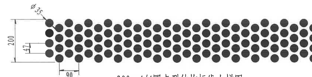
200mm 4/4 圆点型结构标线大样图
