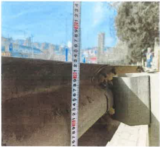
图 2 护栏板高度测量
