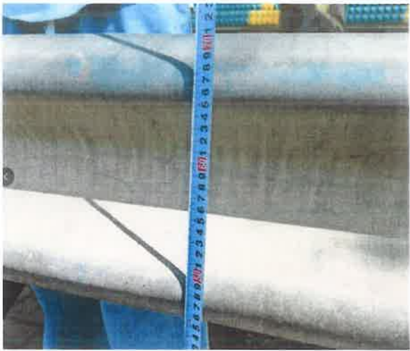
图 1 护栏板高度测量
