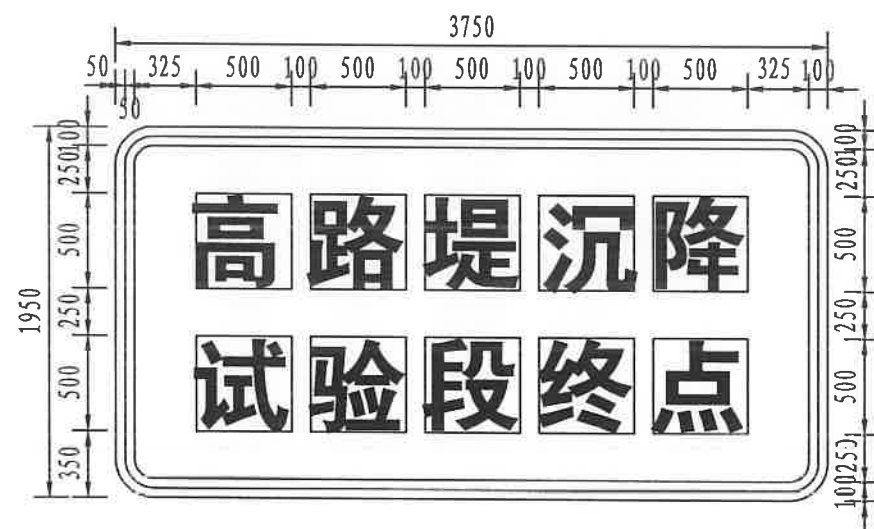
高路堤沉降 试验段终点 版面颜色白底黑字，黑边框、白衬边
